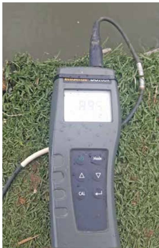
Modelo de oxímetro – aparelho para medir os teores de oxigenação de um lago.
